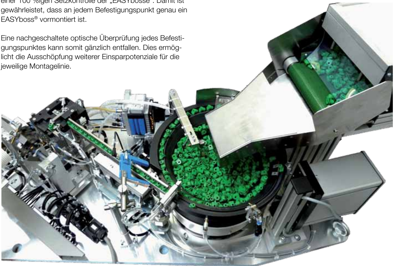
Anlage des Schraubtechnik- und Automationsspezialisten DEPRAG für die automatische Zuführung, Vereinzelung und Lageorientierung der „EASYbosse“
