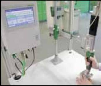
Adaptives Schraubverfahren DEPRAG CFC Clamp Force Control: Trotz schwankender Eindrehmomente garantiert das Verfahren eine zuverlässige Erkennung der Kopfauflage und sichert einen einheitlichen Ausgangszustand für den nachfolgenden Endanzug mit dem Ergebnis einer konstanten Vorspannkraft.
