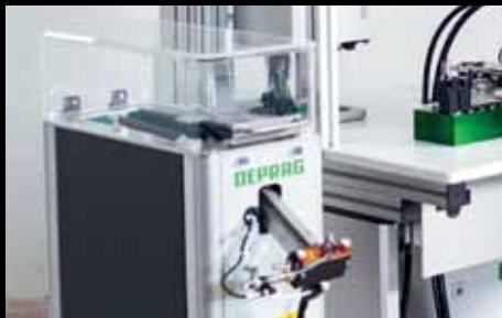
Distribution générant peu de frottement entre les composants avec le système d'alimentation à balancier DEPRAG
