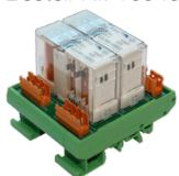
Das Modul „Sicherer Halt“ trennt die Versorgungsspannung zum Schrauber. Die Spannungsversorgung für die Stromversorgung bleibt dabei erhalten. Die Auftrennung ist 2-kanalig mit Rückmeldekontakten ausgeführt, so dass ein Performance Level e nach EN ISO 13849-1 erreichbar ist (Funktionale Sicherheit).
